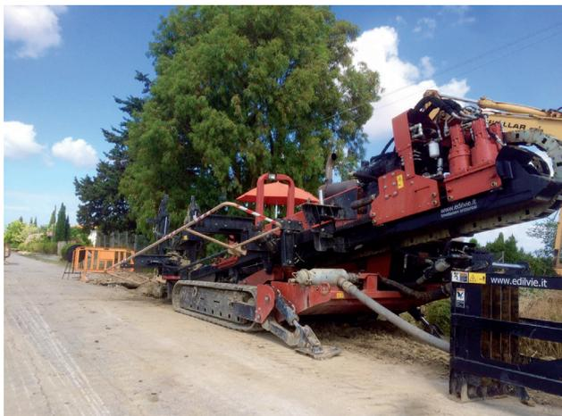
*Fig.3: La macchina trivellatrice utilizzata per realizzare il TOT*
